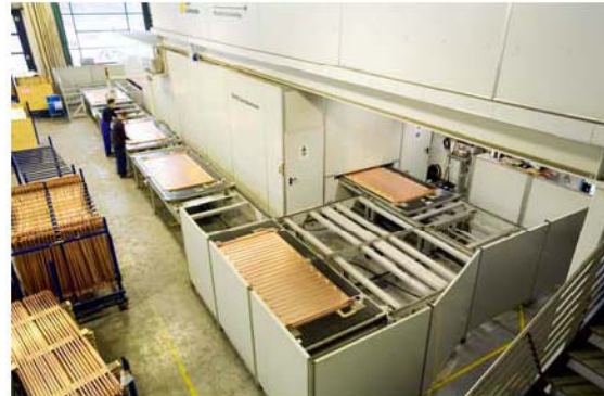
Foto2: Impianto di saldatura al laser con assorbitori in rame
