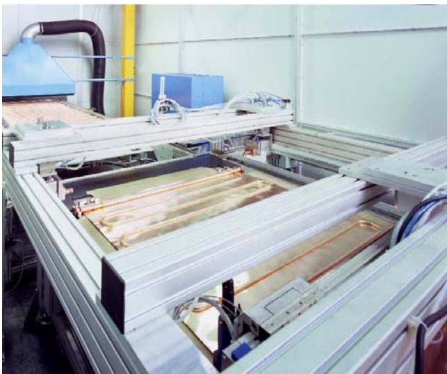
Foto3: Controllo di qualità attraverso la verifica di resistenza alla pressione
