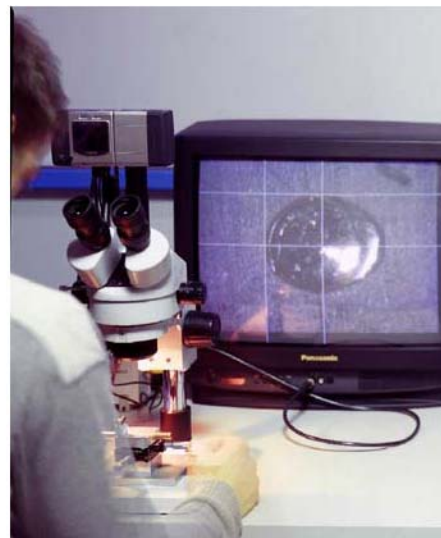
Foto4: Controllo dei punti di saldatura
