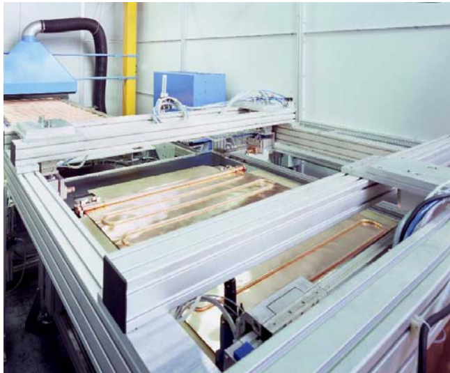
Abb. 3 Qualitätskontrolle mit Druckdichtigkeitsprüfung
