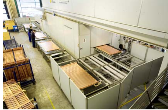
Abb. 2 Laserschweißanlage mit Kupfer-Absorbern
