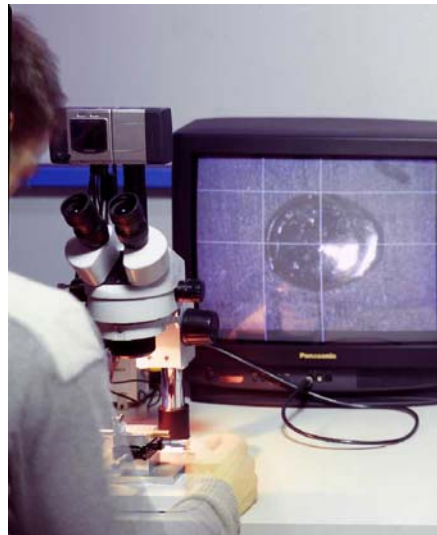
Abb. 4 Kontrolle der Laserschweißpunkte
